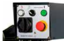
Panel de control con selector de bajada manual o controlada
