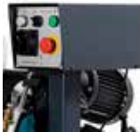
Panel de control con selector de bajada manual o controlada
