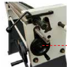
Volantes de ajuste de distancia entre rodillos
