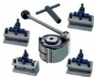
Torreta de cambio rápido montada de serie
